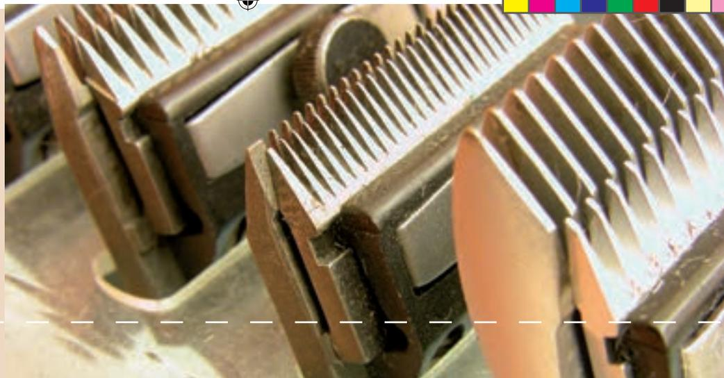
trocknen lassen. Am nächsten Tag, einfach wieder etwas Öl auf den Scherkopf geben und der Scherkopf ist einsatzbereit. Diese Art der Reinigung erhöht die Haltbarkeit der Scherköpfe bis zu 20% bis zum nächsten Schleifen. Am besten sollten Sie diese Art der Reinigung der Scherköpfe täglich durchführen.
